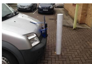
Paletto di 1 m davanti a una telecamera montata a 0,6 m di altezza
